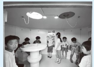
町内のこども園は津波浸水想定区域内にあり、避難対策が差し迫る課題となっています。町では、対策の一案として津波避難シェルターの導入を検討しています。シェルターは発泡スチロール製で、表面にポリウレタンを吹き付け塗装しており、耐衝撃性・断熱性に優れ、激流の中でも沈まない構造ということです。
