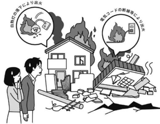
地震による火災のうち、照明機器や電気コードなどが原因となる電気火災が半数以上を占めています。地震に伴う電気火災への対策として、揺れを感知したときに自動でブレーカーが落ちる「感震ブレーカー」は、急いで避難するときはもちろん、外出中の地震でも自動でブレーカーが落ちるため、とても有効な手段です。
