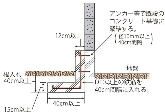
※Dは異形鉄筋を、その後ろの数字は鉄筋の直径を表します。 (単位 : mm)
