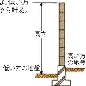
側溝に沿ったところは、側溝の底から計る。
